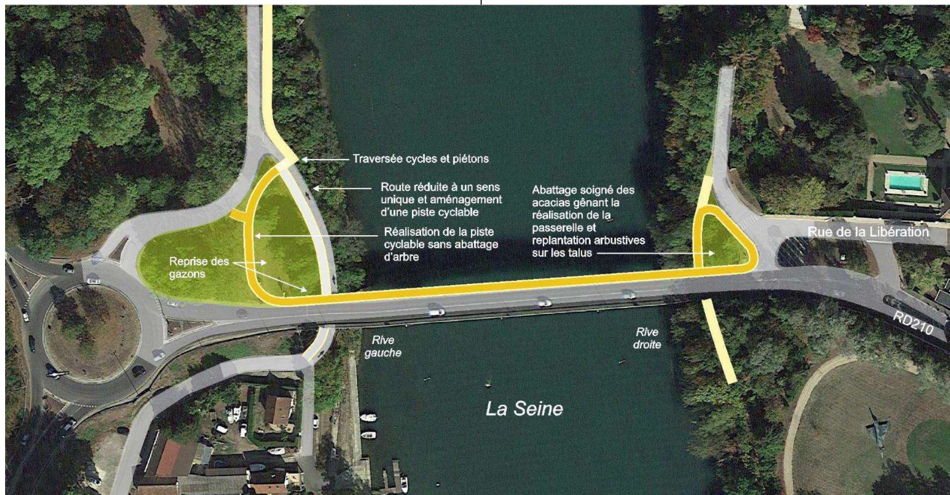
Pont de Valvins - Création d'une passerelle piétons cycles en encorbellement
